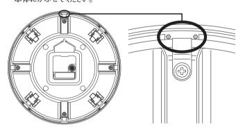
■時計本体裏面にある4カ所のツマミを外側に向かってスライドさせ、ケー スのガイドに差し込みます。下の図のように外周○のマークが合う位置 でロックされます。4カ所とも確実にロックされたことを確認してください。
