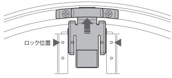
■ケースを外す場合は上記と逆の手順でツマミを内側に向かってスライド させロックを外します。その際、ツマミ部分を手前に持ち上げながら動か すとスムースにスライドします。4カ所とも同様に外してください。
